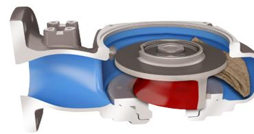
**Этап 2.** Твердые предметы перемещаются вдоль верхнего конца лопасти рабочего колеса по разгрузочной канавке. Направляющий штифт во вставном кольце проталкивает все типы твердых предметов от центра рабочего колеса, вдоль передней кромки и далее - на выход через разгрузочную канавку.
