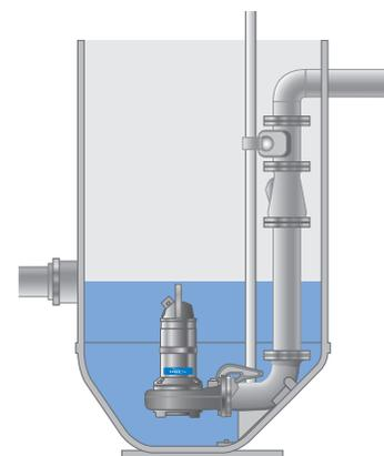
Установите готовую к использованию насосную станцию Flygt из усиленного стекловолоконного полимера (GRP), предварительно укомплектованную насосом, клапанами, напорным трубопроводом, впускным и выпускными патрубками.
