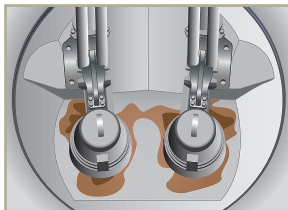
Оптимизированная геометрия выводит любые твердые предметы, оставшиеся в приемке около насосов, где всасывание наиболее сильное. Это препятствует накоплению твердых частиц.
