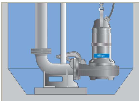
Обычный приемок с широким плоским дном способствует повышенному накоплению ила и твердых частиц.
