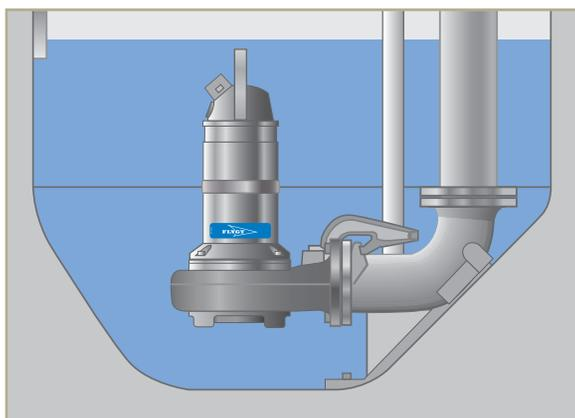
Минимальная площадь дна и оптимизированная геометрия повышают скорость перекачивания среды, что эффективно препятствует оседанию твердых частиц в сточных водах.
