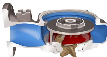
**Этап 1.** Большинство твердых предметов, попадающих в насос, проходит сквозь рабочее колесо между его лопастями. Если твердый предмет задерживается на передней кромке одной из лопастей, то он соскальзывает вдоль загнутой назад кромки к периметру впуска.
