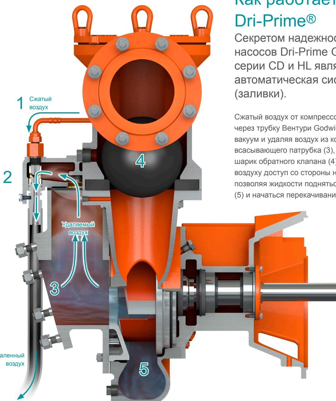
Сжатый воздух от компрессора (1) проходит через трубку Вентури Godwin (2), создавая вакуум и удаляя воздух из корпуса насоса и всасывающего патрубка (3), а в это время шарик обратного клапана (4) преграждает воздуху доступ со стороны напорной части, позволяя жидкости подняться в корпус насоса (5) и начаться перекачиванию.
