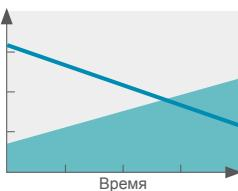
В процессе непрерывной эксплуатации по мере засорения насоса эффективность снижается.
