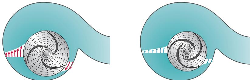
Стандартная конструкция гидравлики заставляет шлам двигаться на высокой скорости
