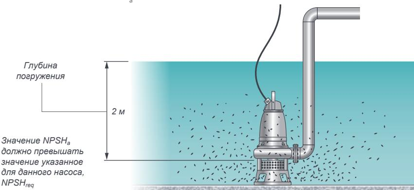
\*  $NPSH_{req}$  = NPSH требуемый,  $NPSH_a$  = NPSH рабочий
