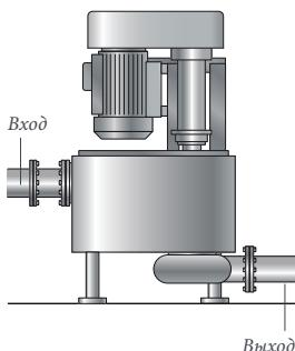
**Полупогружные насосы** считаются насосами полусухого монтажа, поскольку гидравлическая часть погружена в шлам, в то время как электродвигатель и опора насоса монтируются в сухом месте.
