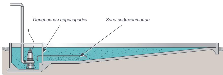
Отстойники меньшего размера за счет наклонных стен создают турбулентность и высокую скорость в отстойнике, предотвращая осаждение шлама. Оседающие твердые частицы соскальзывают непосредственно в зону под входным отверстием насоса.
