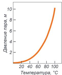
Давление пара для воды при различных температурах
