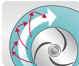
Стандартное колесо отбрасывает твердые частицы на внутреннюю стенку улитки
