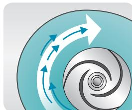
Колесо Flygt заставляет твердые частицы продолжать движение вместе с потоком
