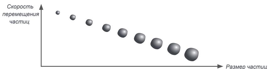
Высокая скорость перемещения и/или частицы малых размеров означают, что все частицы находятся в суспензии. Шлам ведет себя как псевдооднородная смесь.
