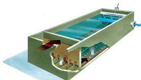
Решение ICEAS является комплектной системой биологической очистки, которая обеспечивает экономичную обработку сточных вод до требуемого качества очистки на выходе. Гибкая, простая и энергоэффективная система включает мелкопузырчатые
