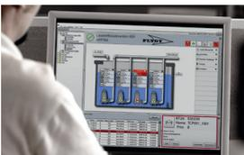
Система диспетчерского управления и сбора данных Flygt AquaView SCADA позволяет дистанционно управлять подключенными к сети станциями или оборудованием, обеспечивая полный обзор рабочего состояния.
