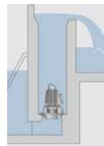
Полустационарная установка насоса в вертикальной колонне из стали или бетона.
