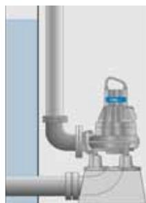
Вертикальная стационарная установка в сухом отделении или линейная установка с фланцевыми соединениями для всасывающих и нагнетательных трубопроводов.
