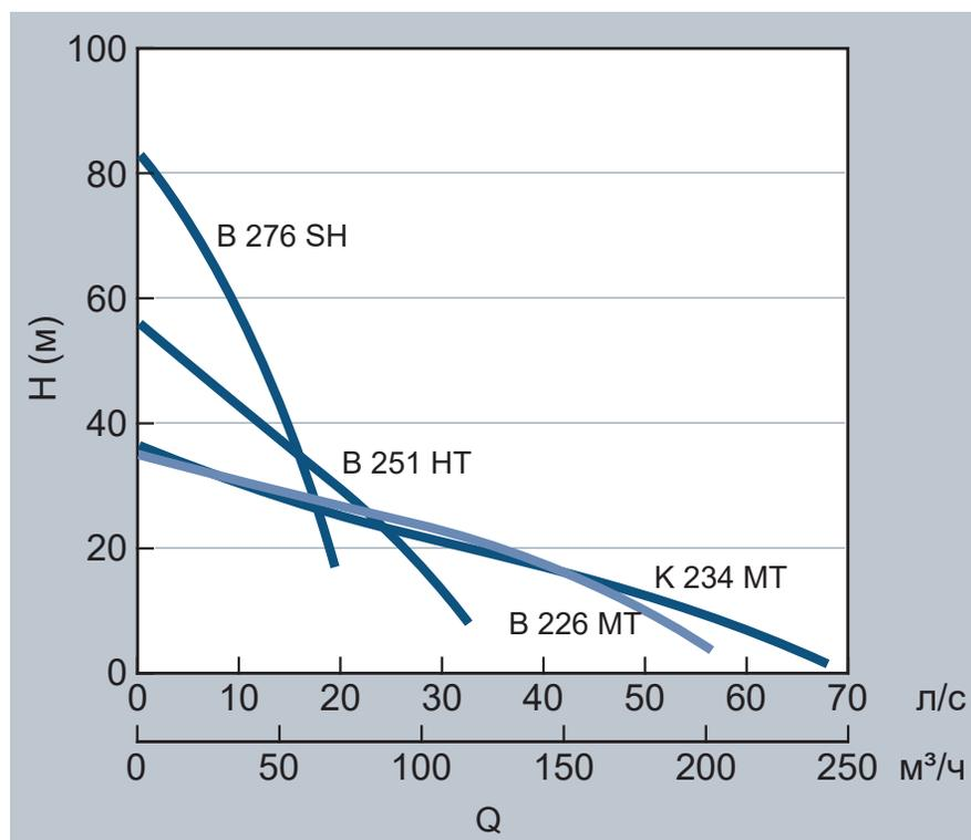
B = Износостойкая крыльчатка. K = Крыльчатка, защищенная от засорения.
