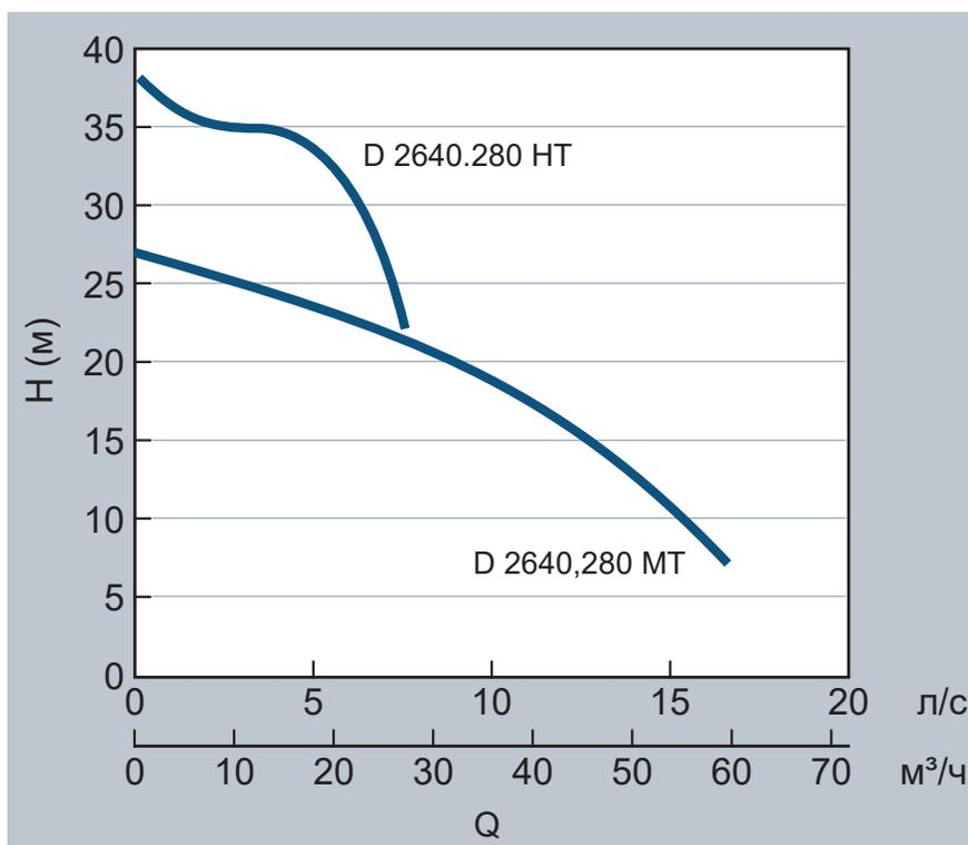
D = Крыльчатка для перекачивания твердых частиц.
