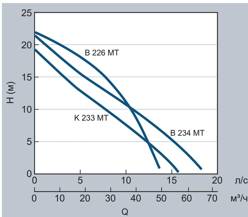
В = Износостойкая крыльчатка. К = Крыльчатка, защищенная от засорения.
