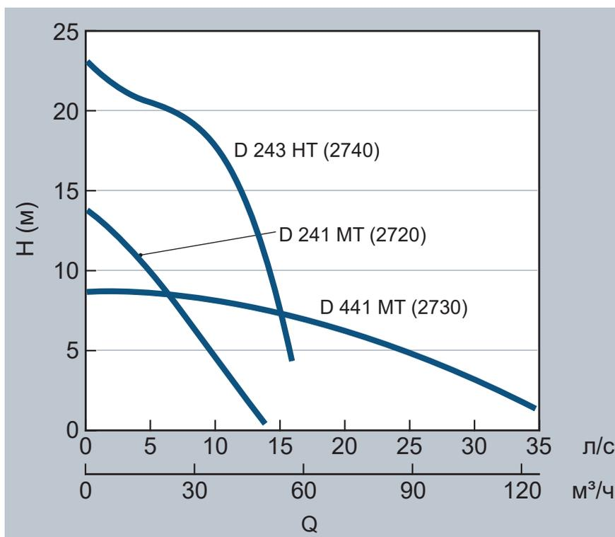
D = Крыльчатка для перекачивания твердых частиц.
