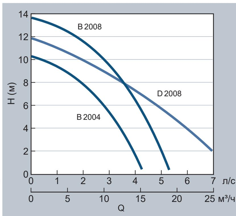
B = Износостойкая крыльчатка. D = Крыльчатка для перекачивания твердых частиц.
