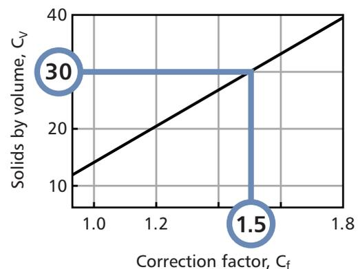
**4. Требуемая рабочая точка** теперь установлена ( $H_{total}$ ). Если концентрация твердых частиц превышает 15% по объему, то напор насоса нужно уменьшить. Разделив рабочий напор на коэффициент уменьшения (HR), получим эквивалентный напор насоса для чистой воды ( $H_{cv}$ ).
