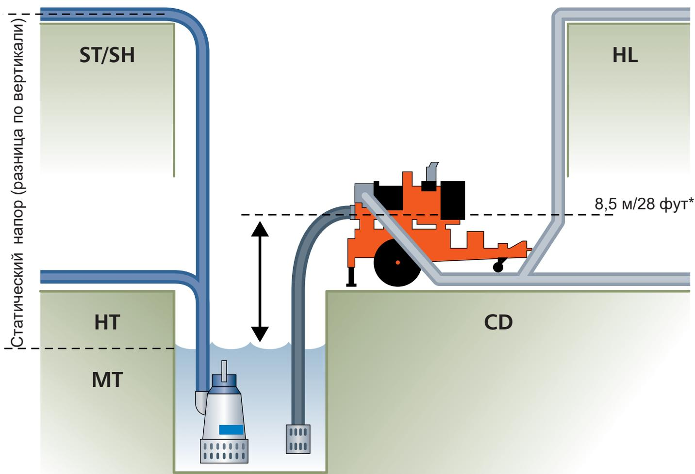
\*Максимальная высота всасывания насоса Dri-Prime равна 8,5 м (28 фут) на уровне моря.
