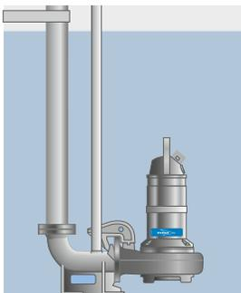
Для полустационарной погружной установки. Насос устанавливается с двумя направляющими штангами на напорном патрубке.
