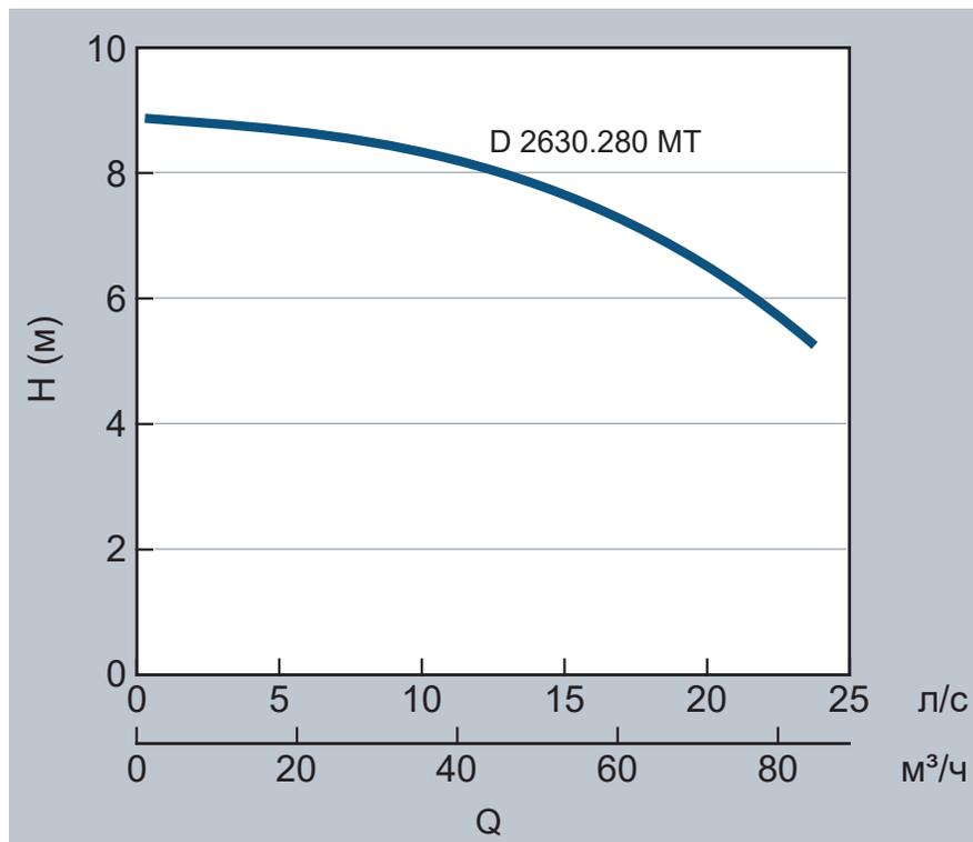
D = Крыльчатка для перекачивания твердых частиц.
