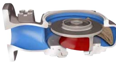
Этап 2. Твердый предмет будет перемещаться вдоль верхнего конца лопасти рабочего колеса по разгрузочной канавке. Направляющий штифт во вставном кольце будет проталкивать все типы твердых предметов от центра рабочего колеса, вдоль передней кромки и далее - на выход через разгрузочную канавку.
