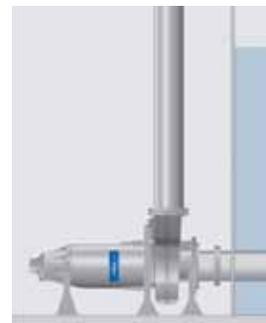
Горизонтальная стационарная установка в сухом отделении или линейная установка с фланцевыми соединениями для всасывающих и нагнетательных трубопроводов.
